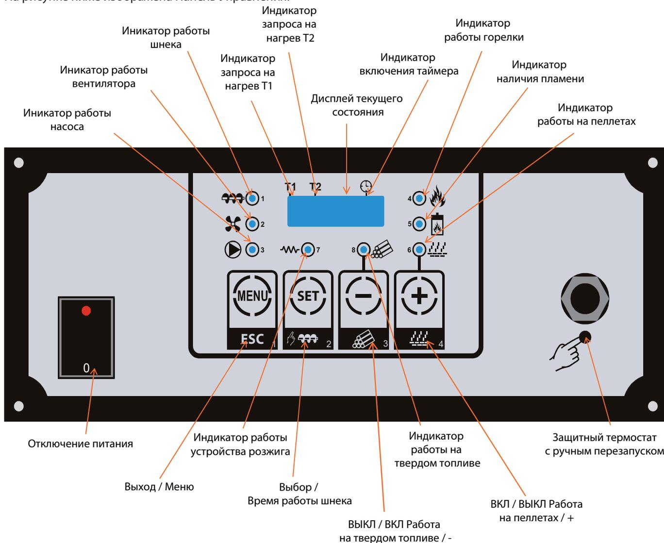
Габаритные размеры Панели Управления: 274 x 108 мм
